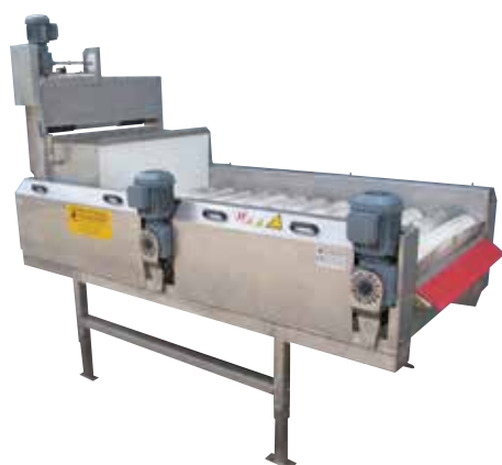
Sécheur à rouleaux avec dégageur électrique et capot avec tuyau de pulvérisation
