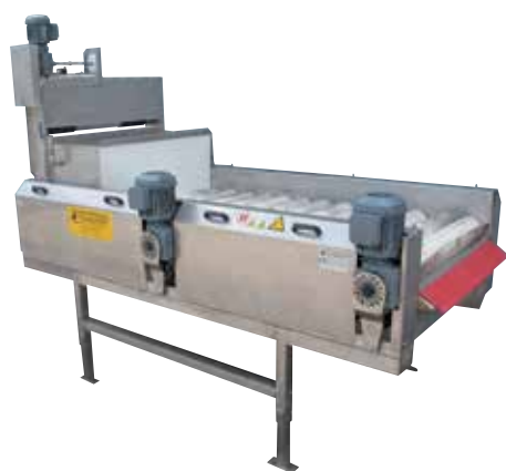
Вальцевая сушилка с электрическим скребком и кожухом с форсункой
